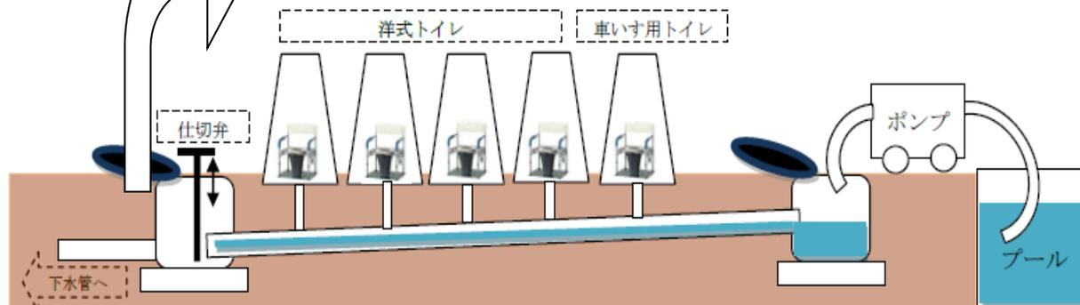
マンホールトイレ用の管にプールから水を溜め、1日1回程度、仕切り弁を上げて汚物を下水管に流す（管には傾斜がついている）。普段はアスファルトにマンホールがあるだけで、見た目はほとんど目立たない。
